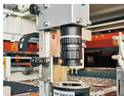
AOI检测系统
